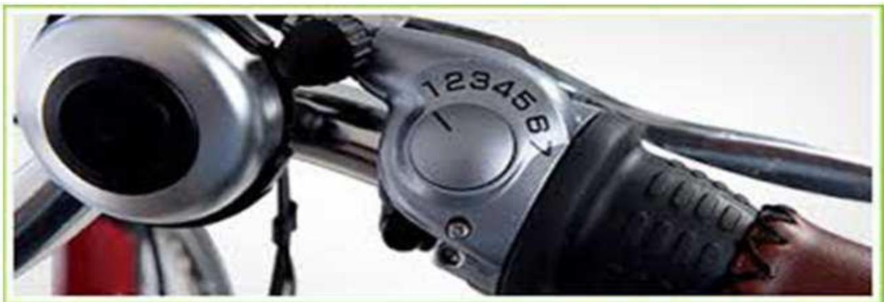
Con l’ingranaggio davanti più piccolo e quello dietro più grande si riesce a far girare molto facilmente i pedali, però in ogni pedalata si percorrono pochi metri. Al contrario, con l’ingranaggio davanti più grande e quello dietro più piccolo (rapporto lungo) si ha maggiore difficoltà a pedalare, ma si percorrono, ad ogni giro del pedale, più metri.
